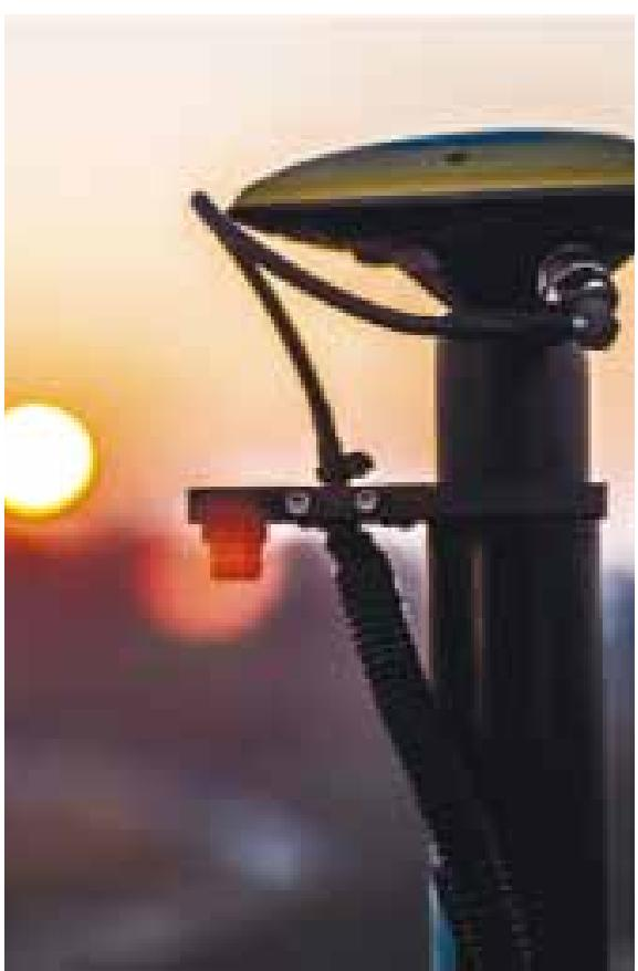
**3D** Система Topcon 3D включает две ГНСС антенны для позиционирования и ориентации машины на участке, четыре датчика наклона с диапазоном определений 360° для измерения углов между кабиной, стрелой, рукоятью и ковшом, спутниковый ГНСС приемник и панель управления GX с цветным сенсорным экраном.
