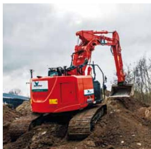
2D система от Topcon позволяет выполнять работы быстро, с высокой надежностью и точностью, в условиях полной безопасности для человека, которому не нужно больше находиться непосредственно у траншеи, чтобы отследить выход на заданный уровень.
